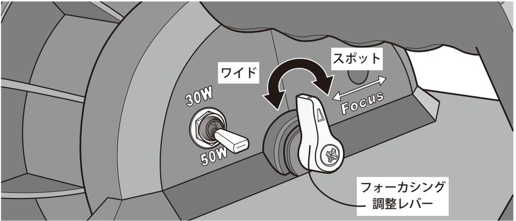
レバー右倒し・・・スポット配光（遠方照射に最適です。）
