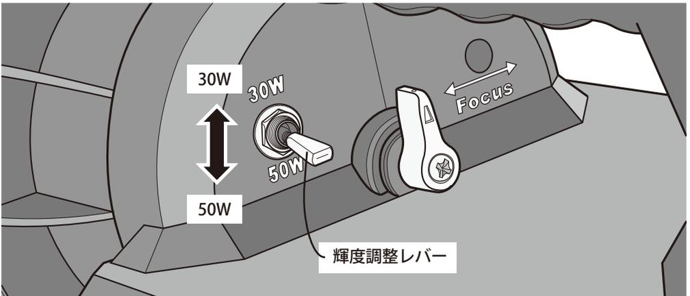
レバーを上げる・・・輝度 30W（照射距離 600m / 光束 2700lm / 連続使用約 3 h 30min）
